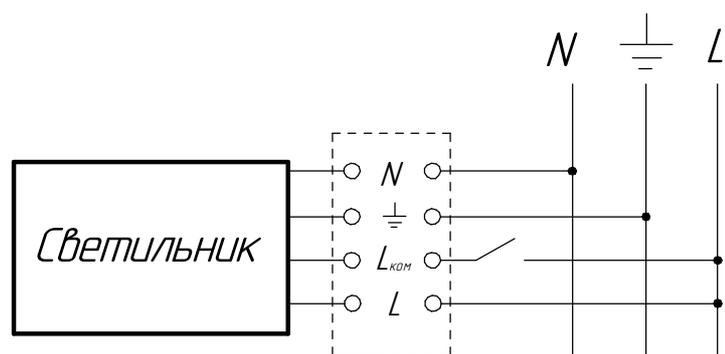
Рис.3 Подключение светильника с БАП к сети.
