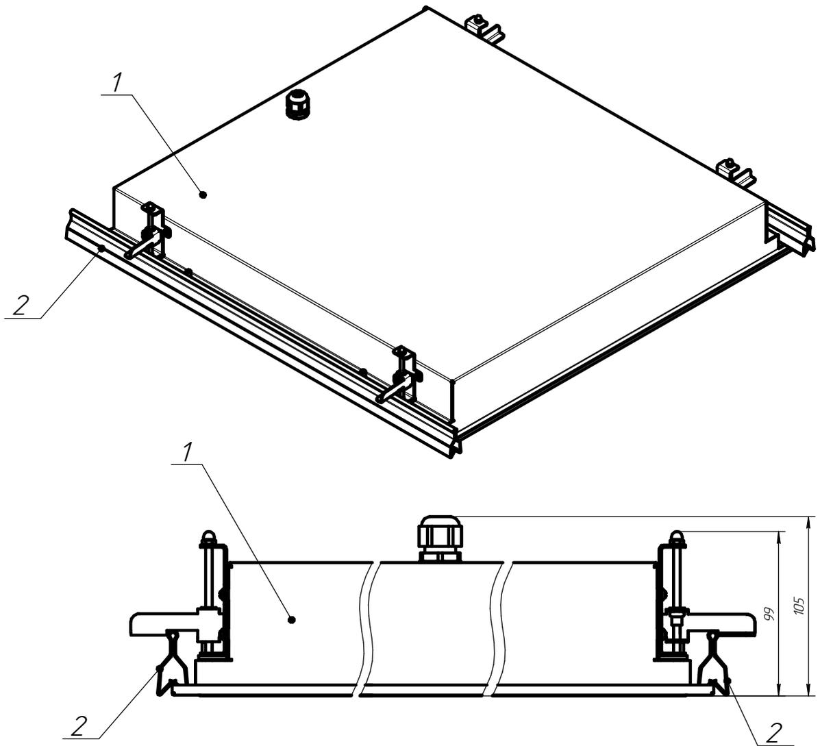
Рис.2.2 Установка светильника в потолок
