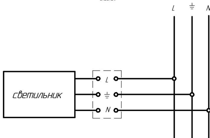
Рисунок 3 - Схема подключения светильника к сети.
