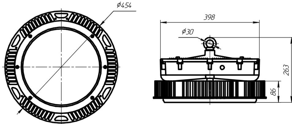
Рисунок 1 - Габаритные размеры светильника ДСП08-XXX-XX1, в мм.
