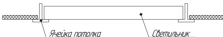
Рисунок 2 - Схема установки светильника в подвесной потолок "Армстронг"
