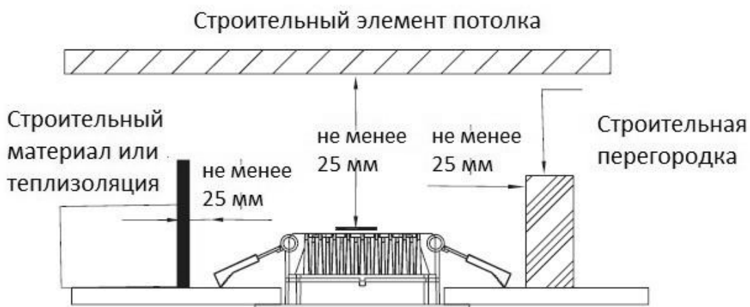
Рисунок 2 - Схема установки светильника в потолок
