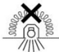
Светильник нельзя закрывать теплоизолирующим материалом.
