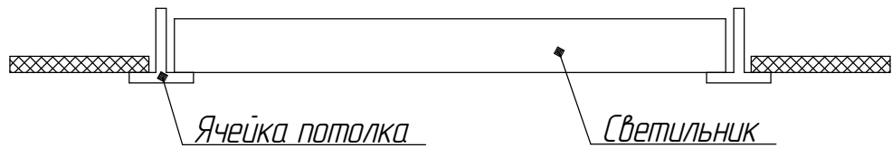
Рисунок 2 - Схема установки светильника
