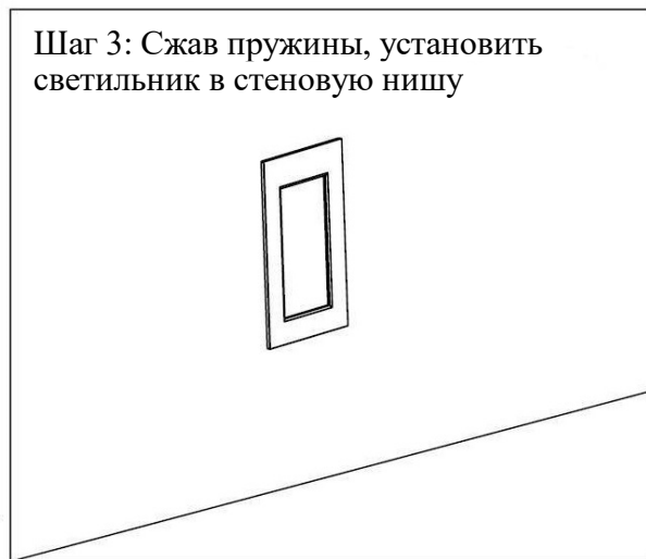
Рисунок 2 - Инструкция по монтажу светильника
