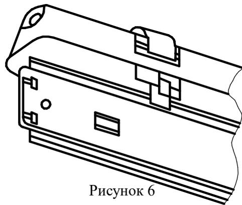
Съем и установка рассеивателя в корпусе
