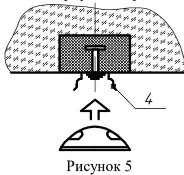
Способ подвеса панели при подключении светильника к сети
