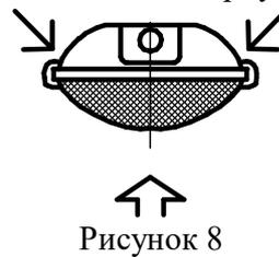
Монтаж при установке светильника в линию
