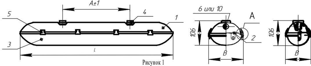
1. Корпус в сборе, 2. Панель в сборе, 3. Рассеиватель, 4. Скоба, 5. Замок, 6. Заглушка, 10. Ввод сальниковый PG16 поставляется по заказу потребителя
