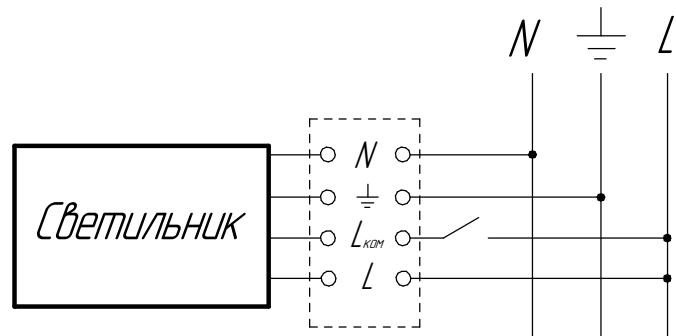
Рис.3 Подключение светильника с БАП к сети.
