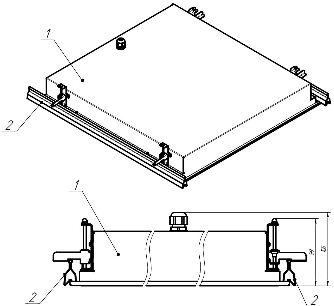
Рис.2.2 Установка светильника в потолок
