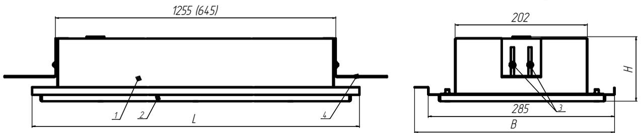
1 - Светильник, 2 - Обечайка; 3 -Крепежные винты; 4 - Кронштейны.
