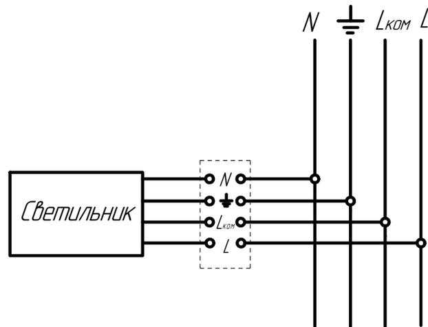
Схема подключения светильника к сети
