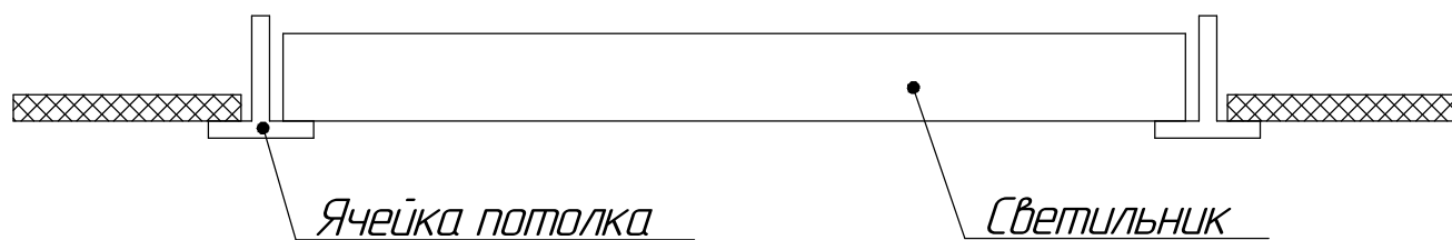
Рисунок 2 - Схема установки светильников
