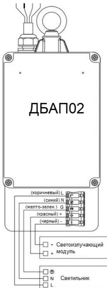
Рисунок 3 - Схема подключения светоизлучающего модуля и светильника к ДБАП02.
