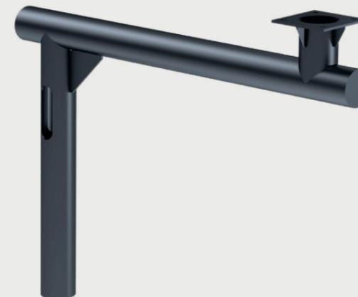
Консольная закладная деталь фундамента – металлическая конструкция для крепления устанавливаемой стальной конструкции (опоры, мачты и т.п.) на фундаментный блок, выполненный из бетона с горизонтальным смещением (вылетом) оси устанавливаемой опоры относительно оси устанавливаемого фундаментного блока.
