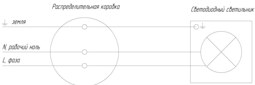
Рисунок 4а - Схема подключения светильника к сети
