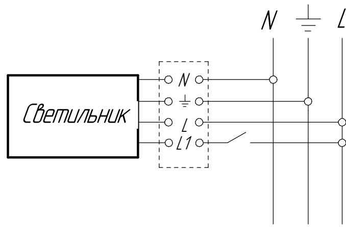
Рисунок 3: Схема подключения светильника с БАП к сети.
