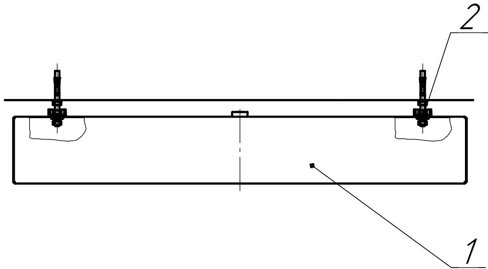
Рис.2.1 Установка светильника.
