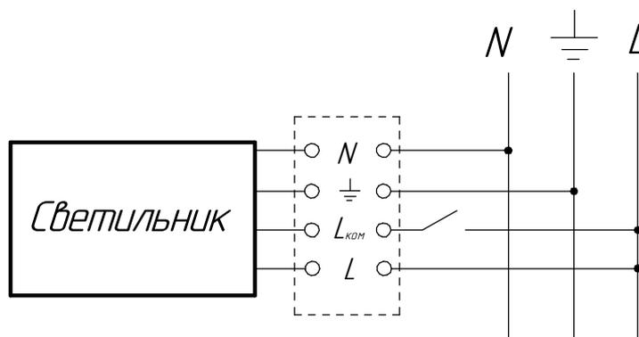
Рис.3 Подключение светильника с БАП к сети.
