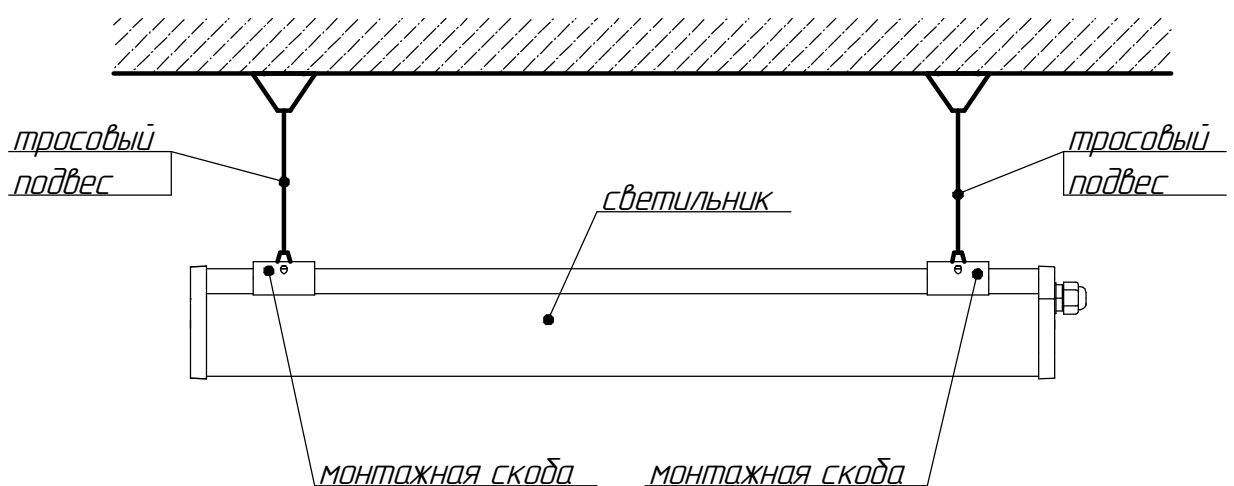
Рисунок 3 - Схема установки светильника на тросовый подвес.
