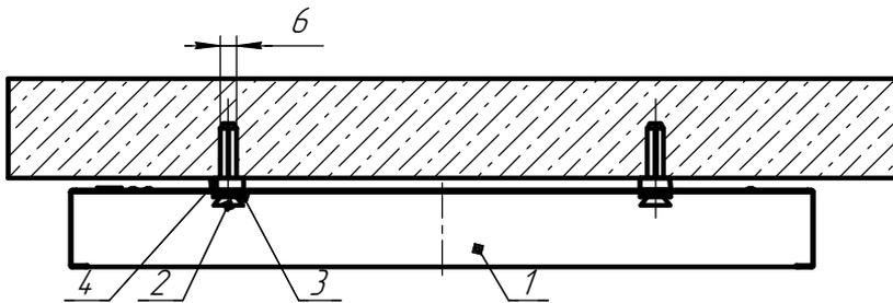
Рисунок 2а - Схема установки светильника на опорную поверхность
