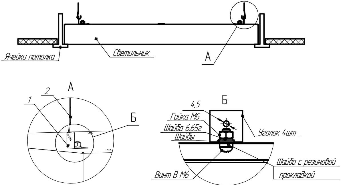
Рисунок 2б - Схема установки светильника в подвесные
