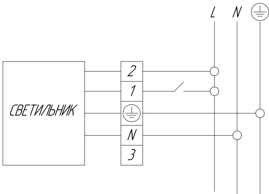
Рисунок 2а - Схема подключения светильников серии
