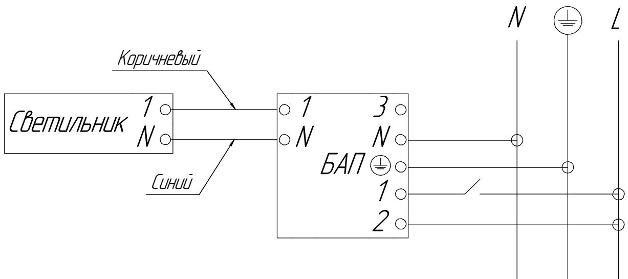
Рисунок 2б - Схема подключения светильников серии
