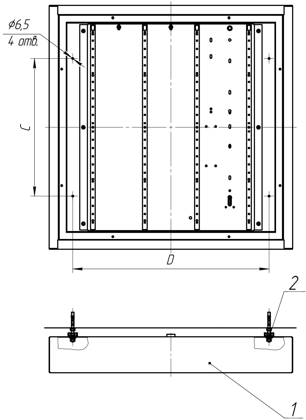
Рис.2.1 Установка светильника.
