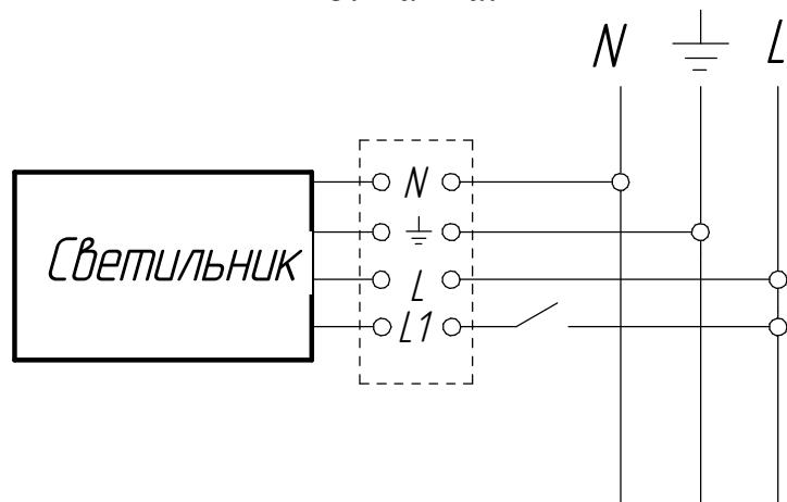
Рисунок 3: Схема подключения светильника с БАП к сети.
