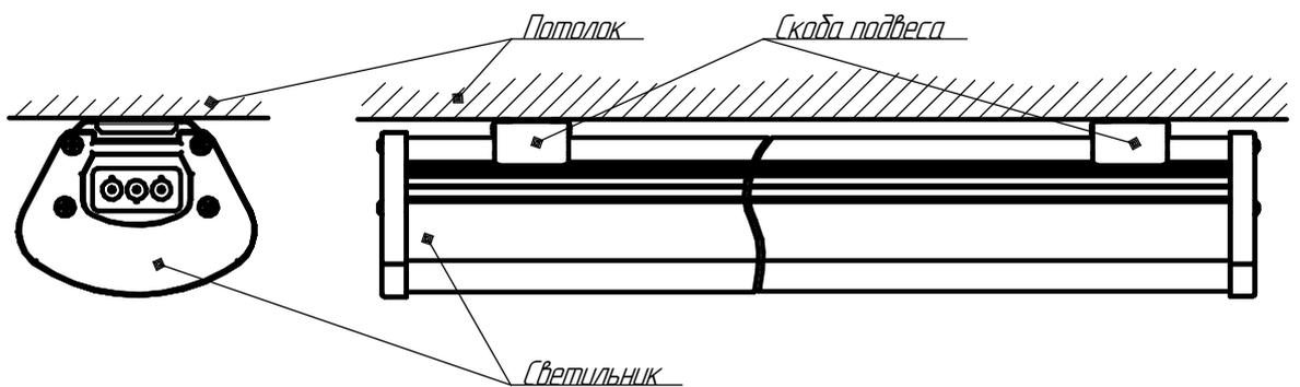
Рисунок 2 - Схема установки светильника на потолке.
