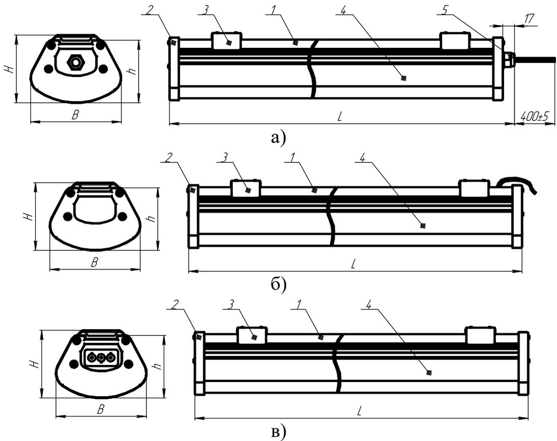
Рисунок 1 - Общий вид светильника серии ДПО48 Prime.
