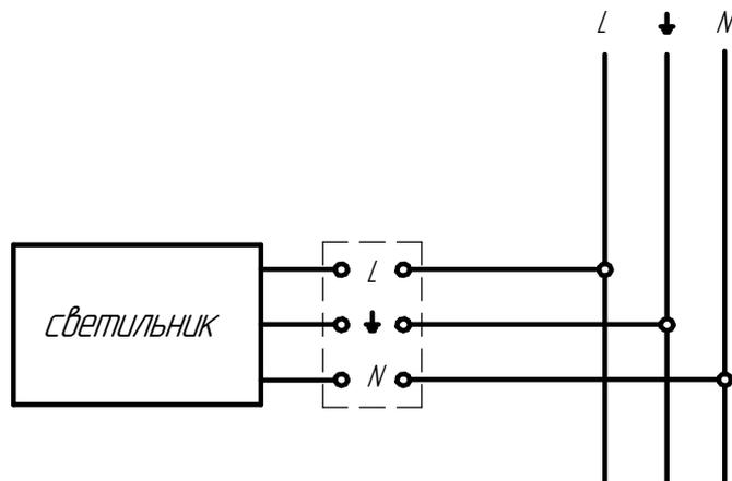
Рисунок 4 - Схема подключения светильника без управления к сети
