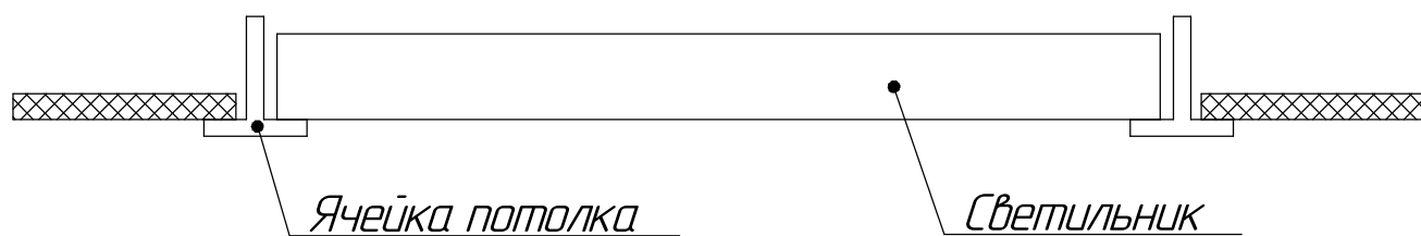
Рисунок 2 - Схема установки светильников
