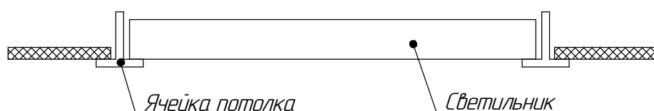
Рисунок 2 - Схема установки светильников
