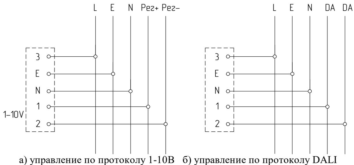
Рисунок 4 - Схема подключения светильников с управлением к сети
