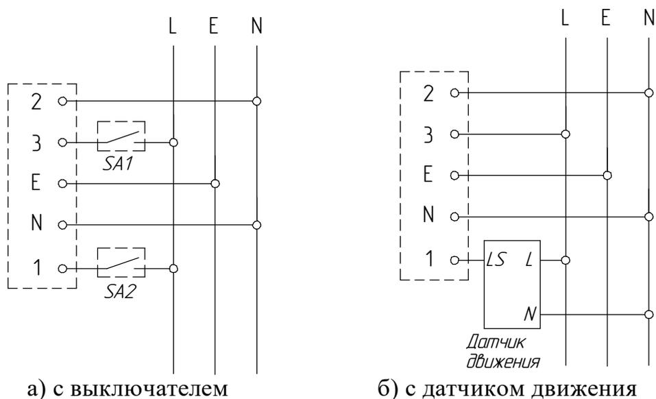
Рисунок 5 - Схема подключения светильников с дежурным режимом
