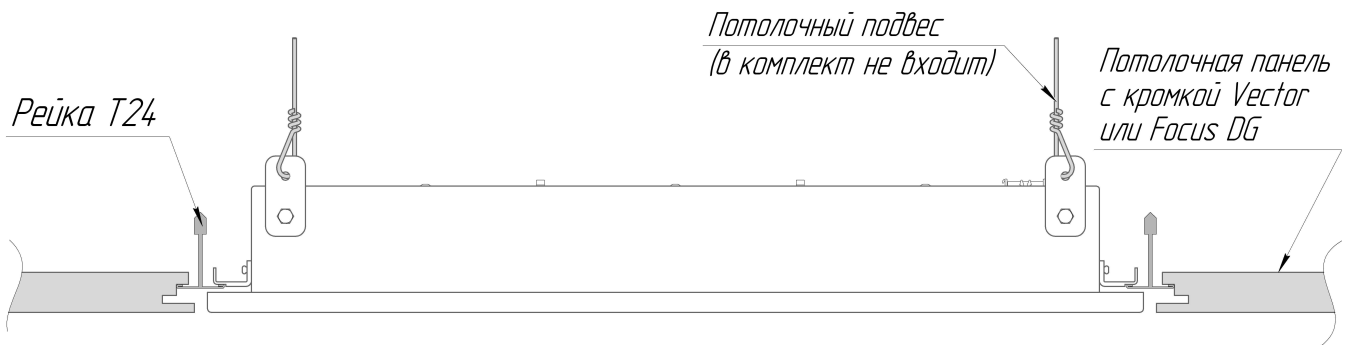
Рисунок 2 - Схема установки светильника ДВО12 VDG
