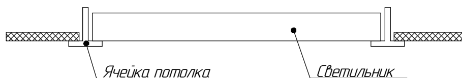
Рисунок 2 - Схема установки Т-образные подвесные системы типа "Армстронг"
