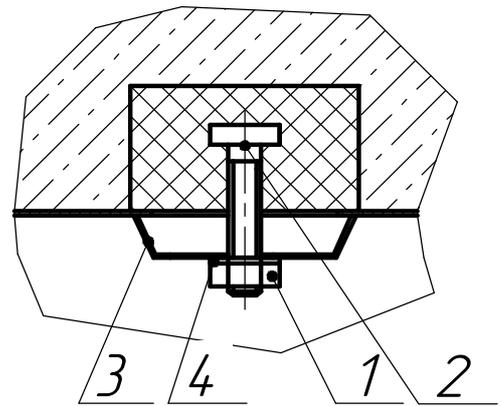
Рисунок.3 Крепление светильника на монтажную поверхность.
