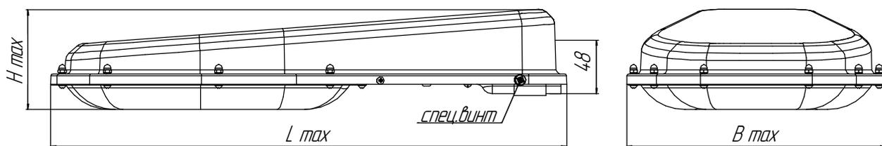
Рисунок 1 - Внешний вид и габариты светильника ДКУ17
