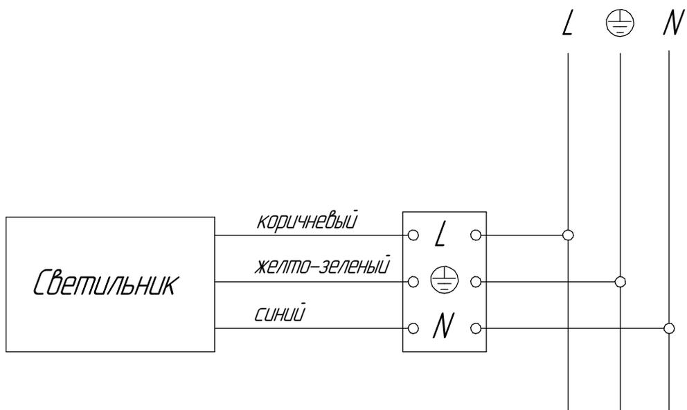
Рисунок 4 - Схема подключения к сети светильников
