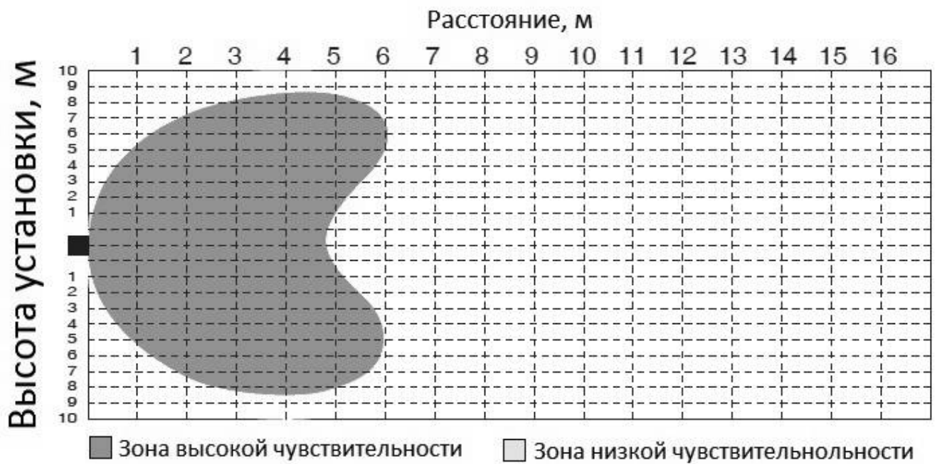
Рисунок 4а - Зона обнаружения датчика движения на светильниках ДБО88 для модификаций -031, -051
