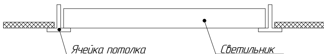
Рисунок 2 - Схема установки светильника
