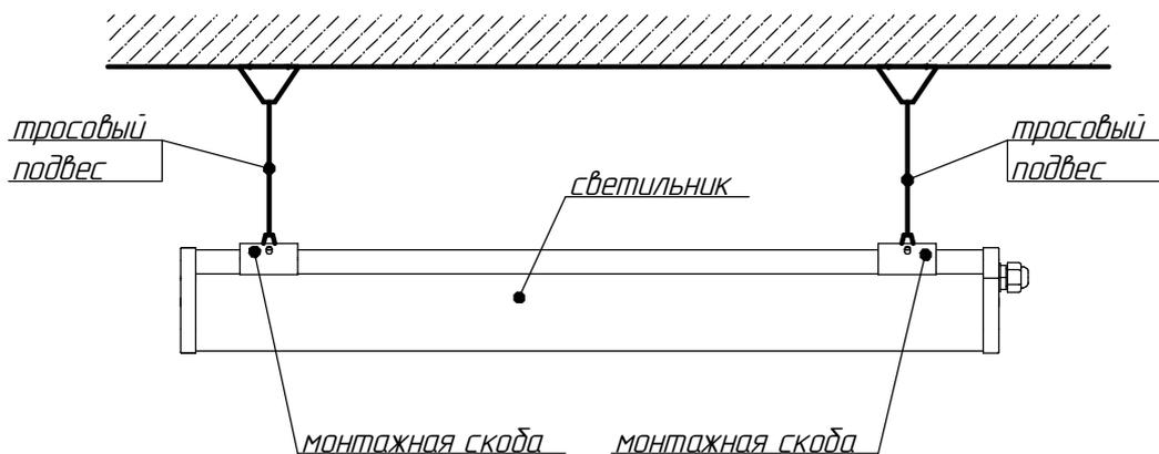
Рисунок 3 - Схема установки светильника на тросовый подвес.
