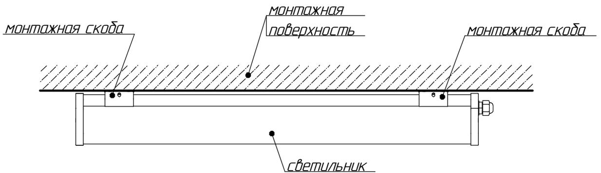
Рисунок 2 - Схема установки светильника на поверхность.
