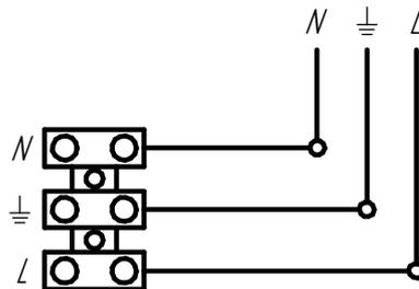
Рисунок 3 - Схема подкдлючения светильника к сети
