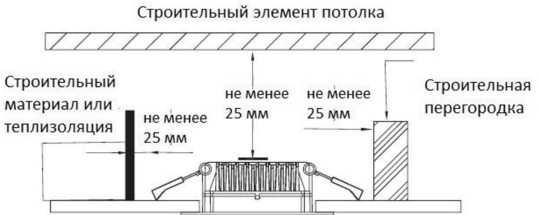
Рисунок 2 - Схема установки светильника в потолок
