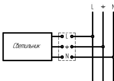
Рисунок 2 - Схема подключения прожектора к сети
