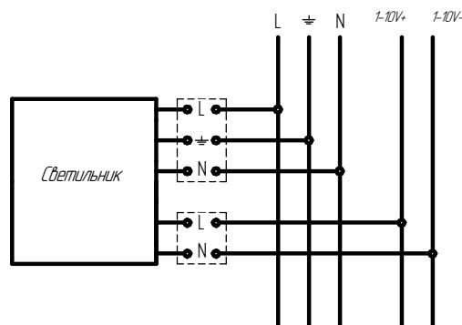
Рисунок 3 - Схема подключения прожектора с управлением к сети
