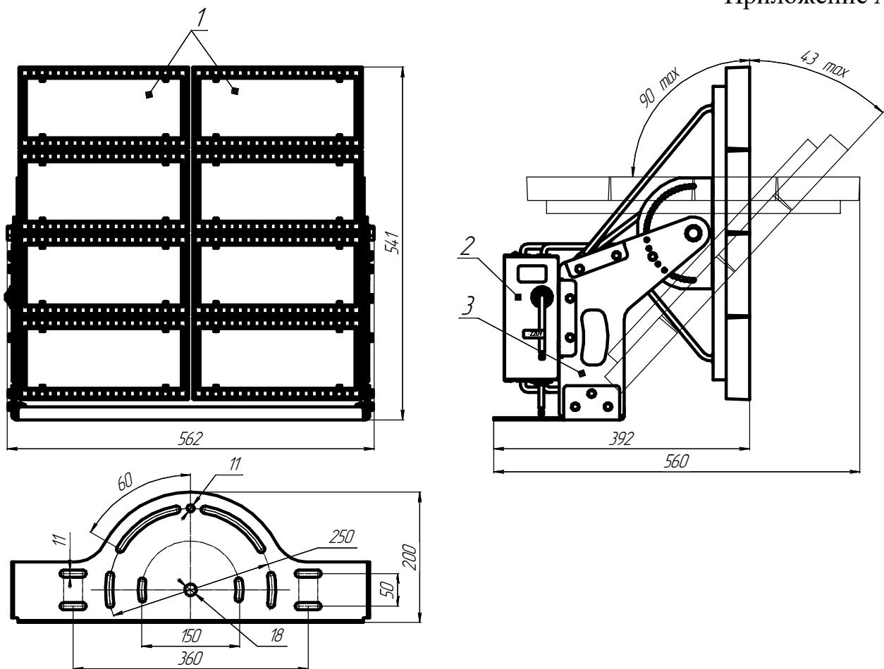
Рисунок 1 - Внешний вид и габариты прожекторов серии ДО16
