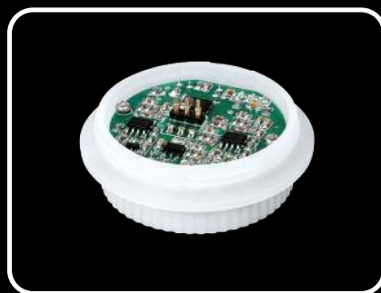
Микроволновый датчик движения
