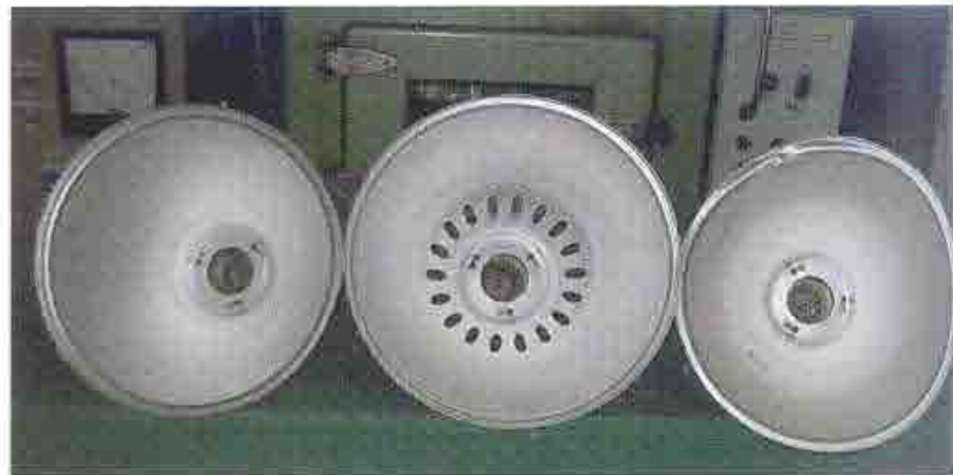
Рис. 5. Светильники с лампой ДРЛ 250 после обработки щелочью и анодирования
