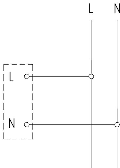
Рисунок 4 - Схема подключения к сети светильника ДВО22.
