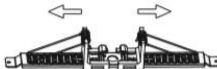
Сдвиньте пружины к краю и снимите их.
