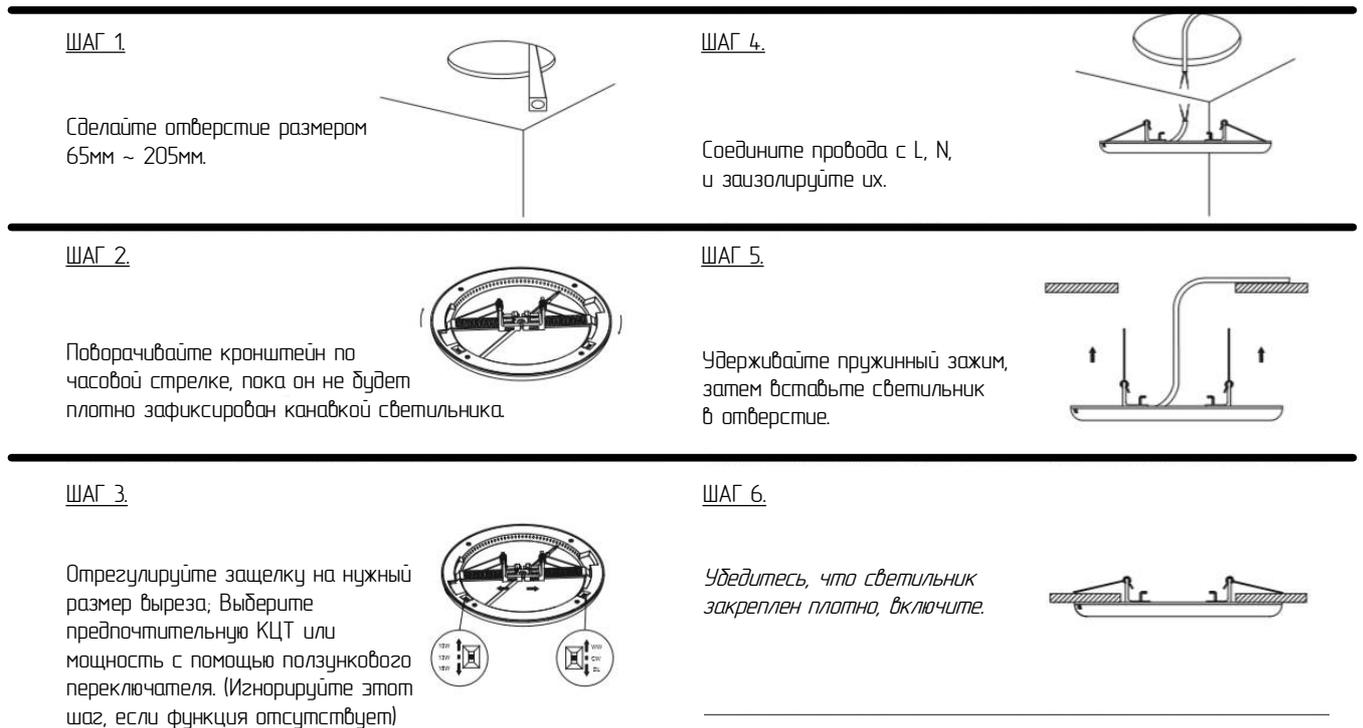
Рисунок 2 - Схема установки светильника в потолок
