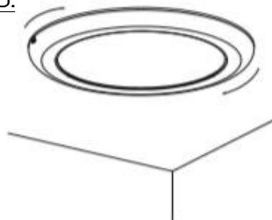
Направьте паз на монтажный кронштейн, поверните светильник по часовой стрелке, пока он не будет надежно закреплен, включите.
