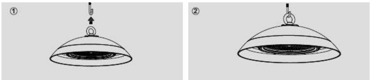
Рисунок 2 - Монтаж светильника с рым болтом.
